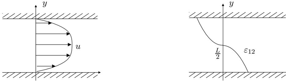
ABBILDUNG 5. Geschwindigkeitsfeld  $u(y)$  (links) und Schergeschwindigkeit  $\varepsilon_{12}(u)$  (rechts)
