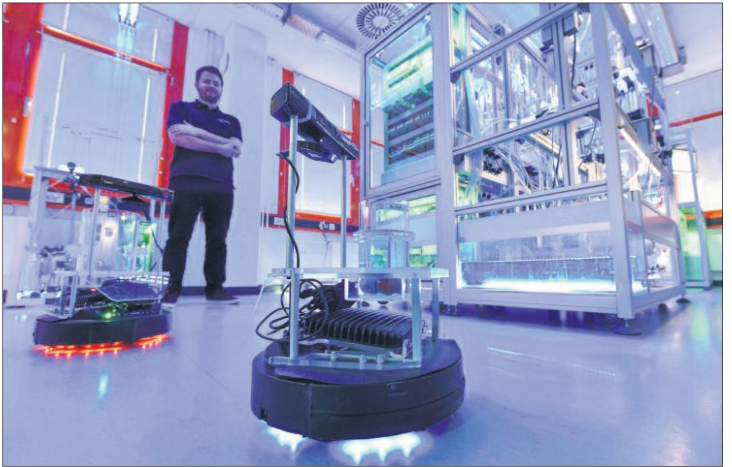
Nimmermüde Helfer in der Getränkefabrik: Die Logistik-Roboter erinnern an selbstfahrende Staubsauger. Sie wirken im Vergleich zur Statur eines Menschen winzig. Sie orientieren sich durch Infrarotkameras, die die Umgebung abscannen. Foto: dpa
