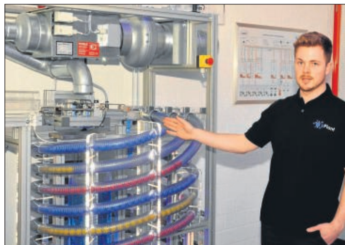
Hier erhält die Limo ihren Geschmack: Wissenschaftlicher Mitarbeiter Alexander Rehmer an der Prozessinsel. Die Roboter „tanken“ hier Farbkugeln, die sich in Wasser auflösen.
