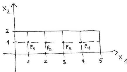
Auf dem Rand gelte:  $f(2, 0) = 1$ ,  $f(2, 2) = 1$  und  $f = 0$  sonst. Geben Sie ein lineares Gleichungssystem in Matrixform zur Berechnung der Lösung in den Punkten:  $P_1 = (1, 1)$ ,  $P_2 = (2, 1)$ ,  $P_3 = (3, 1)$ ,  $P_4 = (4, 1)$ , mit dem Differenzenverfahren:
